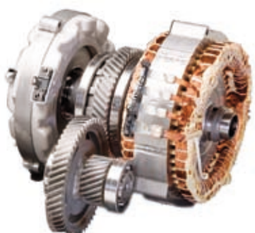
Moteur du Toyota Hybrid System équipant les Prius et Auris Hybrides
