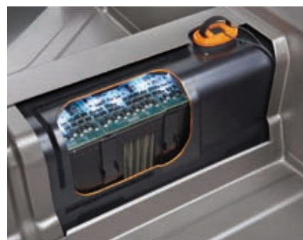
Batteries Li-Ion intégrées dans le châssis de la Volt produite par GM
